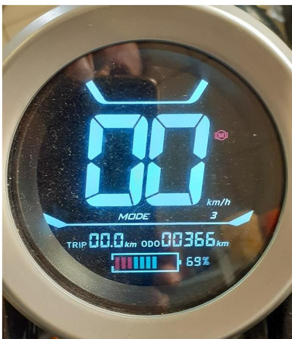
Le symbole moteur s'affiche si on débranche les capteurs moteur
